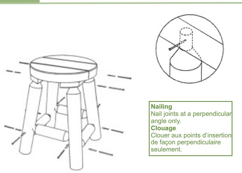
Placer le dessus à plat sur le sol et insérer les pattes, tel qu'ilustré.
